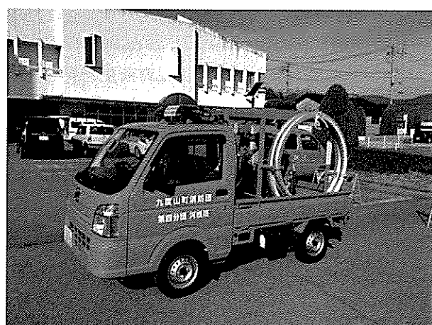
▲小型動力ポンプ付消防積載車(第4分団河根班に更新・配備)
